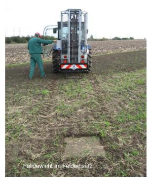
Am Untersuchungsobjekt kommen entsprechend der interessierenden Flächen oder Schnitte Geophone zum Einsatz, mit deren Hilfe die Reflektionen der eingetragenen Schlagenergie aufgezeichnet werden.
